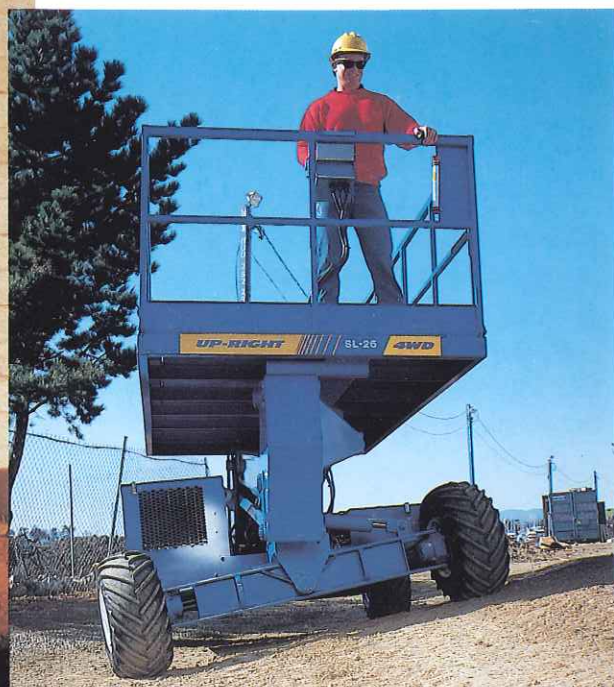
Pendelvorderachse für optimale Gelände-gängigkeit
