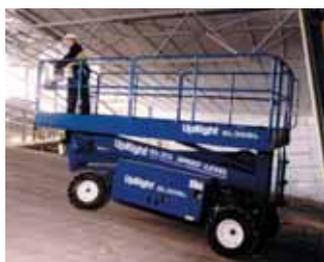
Tous nos modèles disposent d'essieux oscillants pour garder les roues motrices en contact avec les sols accidentés et obtenir une très grande capacité de franchissement en terrains très difficiles et en chargement
