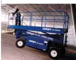
Todos los modelos tienen ejes oscilantes para permitir que las ruedas de tracción estén en contacto con los terrenos desiguales y para permitir mayor nivel de inclinación en las rampas de carga y sitios de difícil acceso.
