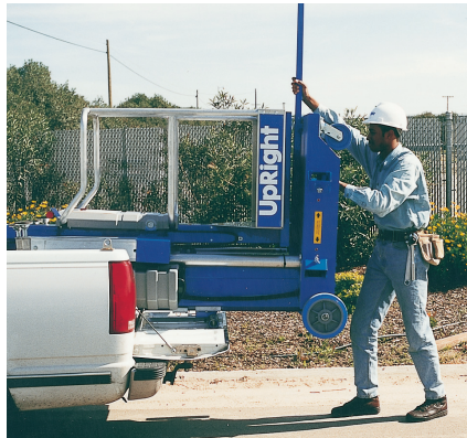
所有型号均配有装载机构，能协助人员装上卡车
