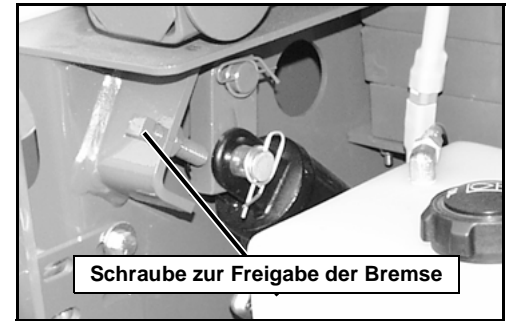
Abbildung 6: Freigabe der Feststellbremse
