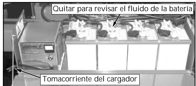
Figura 4: Módulo de potencia del chasis, lado izquierdo
