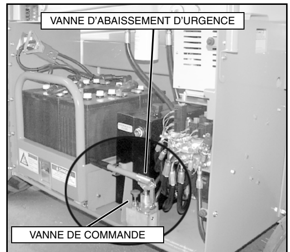
Figure 17 : Bouton de vanne d'abaissement d'urgence, XRT33E
