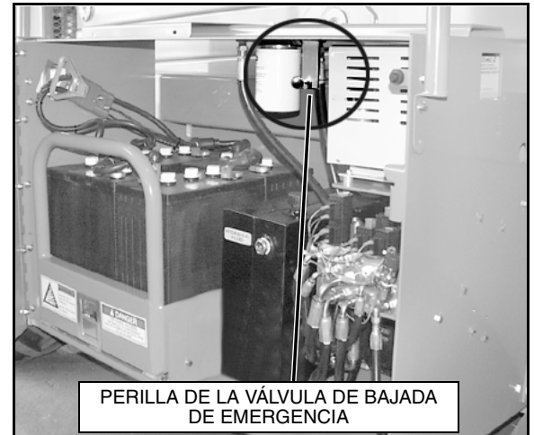
Figura 38: Perilla de la válvula de bajada de emergencia, XRT27E
