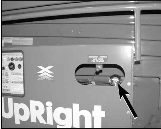
Figure 4 : Bouton de vanne d'abaissement d'urgence (XRT27)
