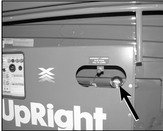
Abbildung 4: Knopf des Notsenkventils (XRT27)
