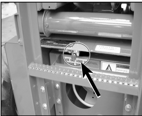
Abbildung 5: Knopf des Notsenkventils (XRT33)
