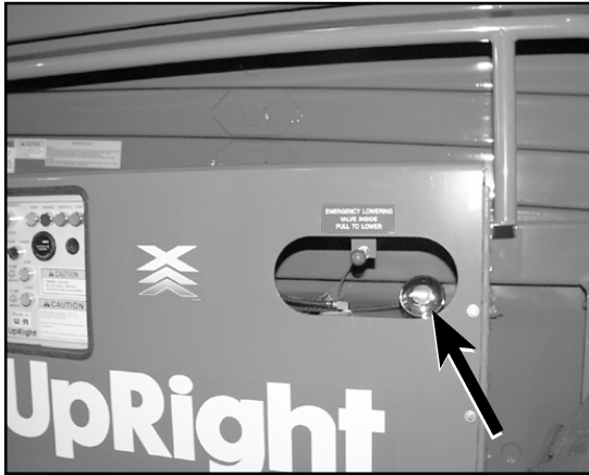
Figura 4: Control de la válvula de bajada de emergencia (XRT27)
