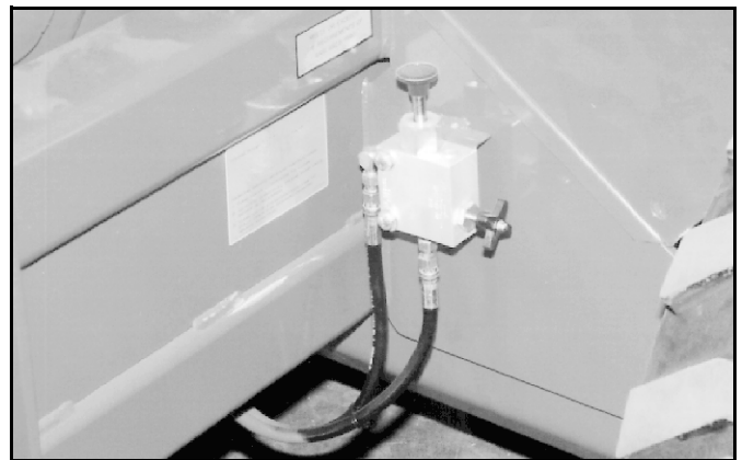
Figura 2: Desenganche del freno de estacionamiento
