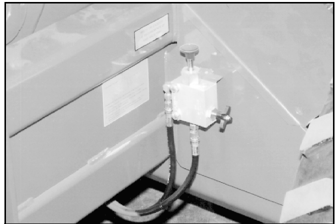
Abbildung 2: Feststellbremsen-Freigabepumpe
