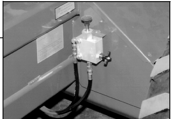
Figure 20 : Pompe de desserrage de frein de stationnement
