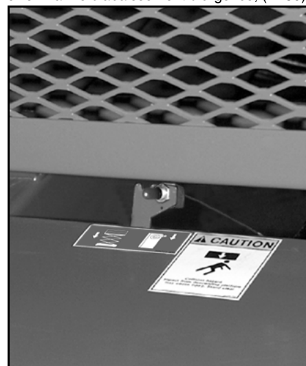
Figure 19 : Vanne d'abaissement d'urgence, (LX50)
