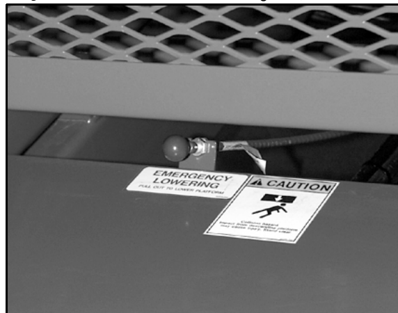
Figure 18 : Vanne d'abaissement d'urgence, LX31 et LX41
