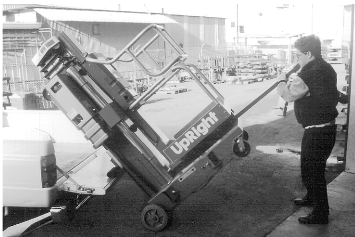
Kippen der Maschine auf und von einem Fahrzeug
