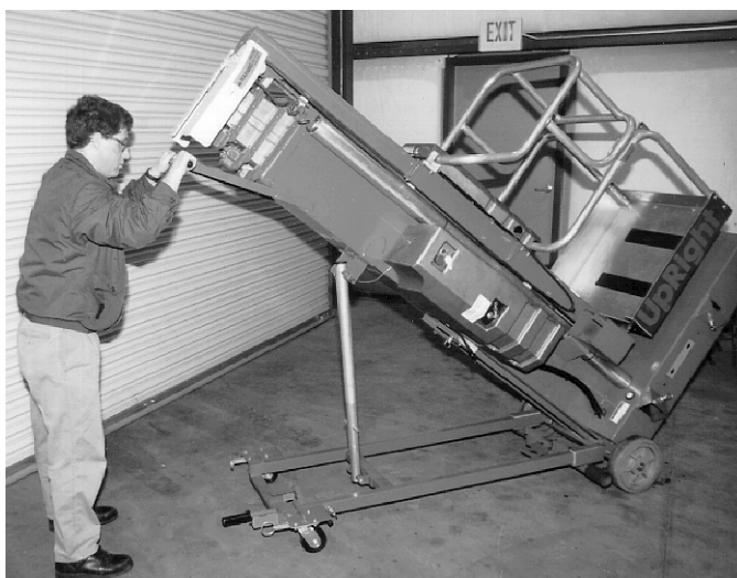
Einfahren der Zylinderbaugruppe
