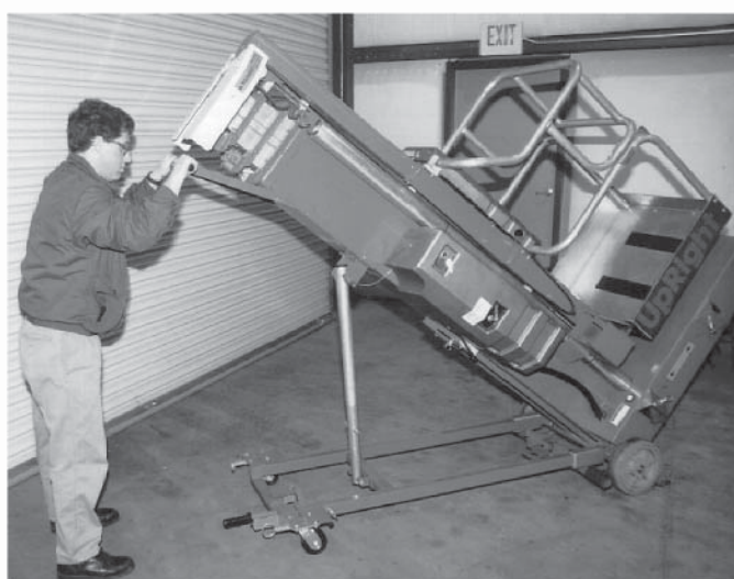
Compressione del gruppo del cilindro
