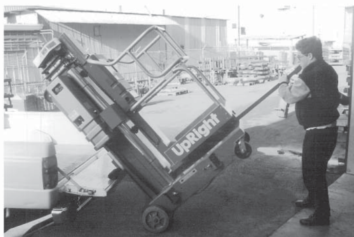
Inclinazione della macchina per le operazioni di carico o di scarico da un veicolo
