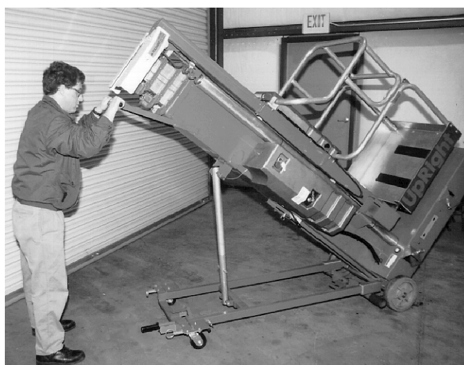
Einfahren der Zylinderbaugruppe
