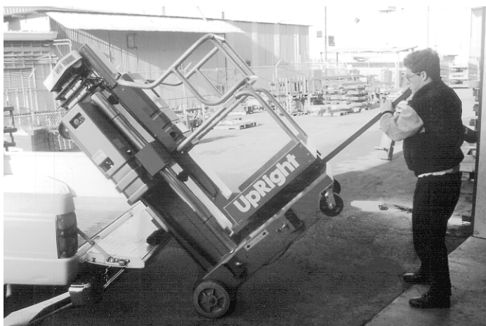
Basculement de la machine pour le chargement sur un véhicule ou le déchargement
