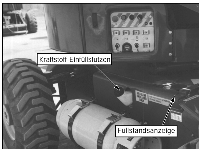
Abbildung 8: Kraftstoff-Einfüllstutzen und Füllstandsanzeige
