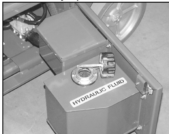
Abbildung 8: Hydraulikbehälter und Ölmesstab
