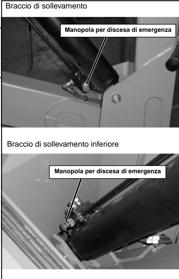
Figura 3: Valvola di discesa di emergenza
