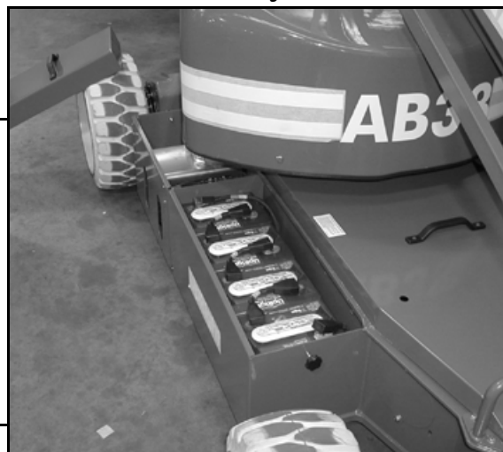
Figura 6: Accesso alle batterie
