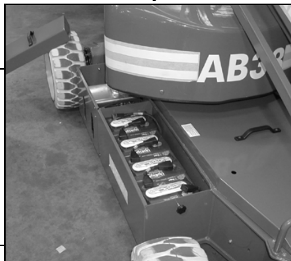
Figure 6: Acceso a las baterías
