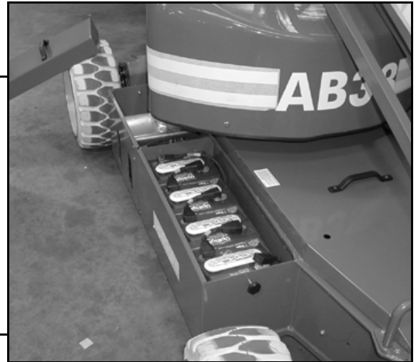
Abbildung 6: Zugriff auf die Batterien
