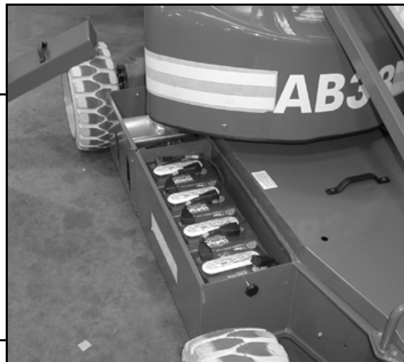
Figura 6: Accesso alle batterie
