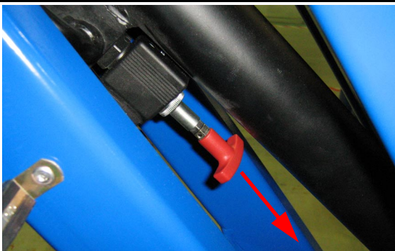
Figure 9 : Abaissement secours - Vanne de bras
