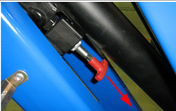
Figura 9: Abbassamento d'emergenza - Valvola Braccio
