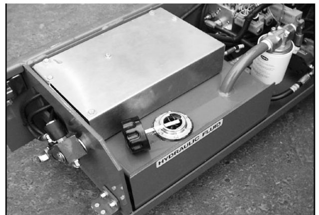
Figura 12: Depósito de líquido hidráulico y varilla
