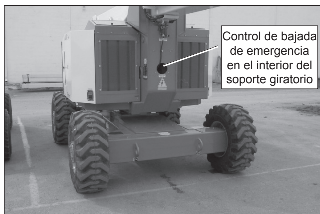
Figura 5 - Control de bajada de emergencia del brazo elevador
