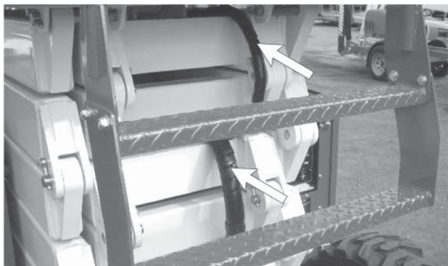
Abb. 7.11 – Verkabelung am Scherenteil
