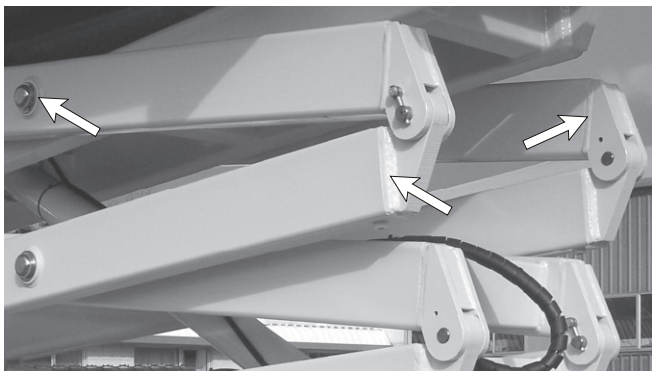
Figuur 7.19 - Structurele schade en lasnaden
