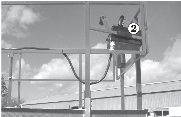
Figuur 6.1.2 - Locatie van het besturingspaneel op het platform
